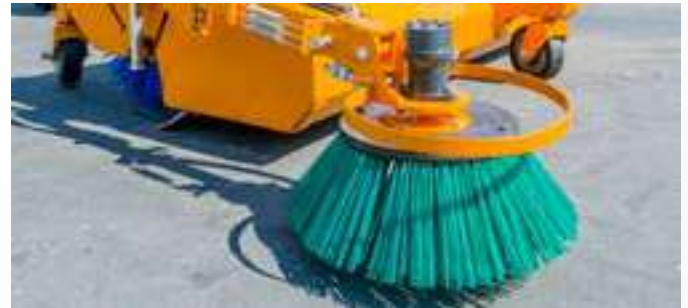
Seitenkehrbesen für das Reinigen an beispielsweise Straßenrändern oder Bordsteinen (kein weiteres Steuergerät erforderlich), optional auch mit Stahlbesatz
