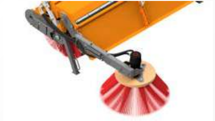
Optionaler Seitenkehrbesen mit hydraulischem Antrieb für das Reinigen an beispielweise Straßenrändern
