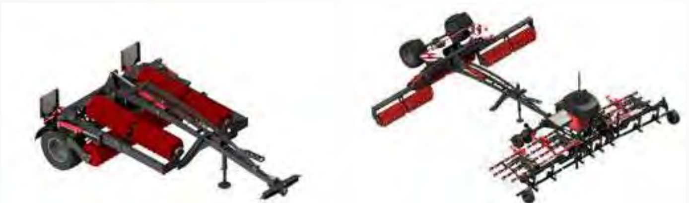
Zahnringwalze ZR im eingeklappten Zustand
