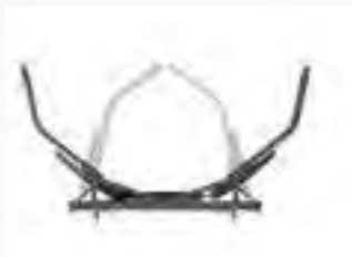
Parallelführung der Haltewangen
