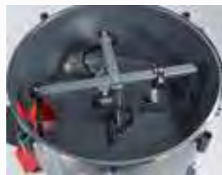
Vier gefederte und nachstellbare Mischschare für die zügige Herstellung einer homogenen Mischung.
