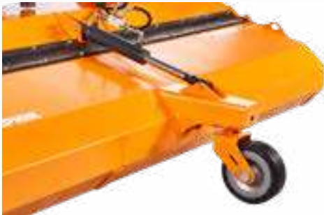
Hydraulische Schmutzsammelwanne mit 3. Stützrad
