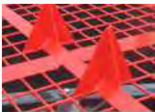
2 Aufreißerspitzen zum Öffnen von Säcken.
