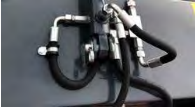
Hydraulische Entleerung für eine einfache Entleerung (kein weiteres Steuergerät erforderlich)
