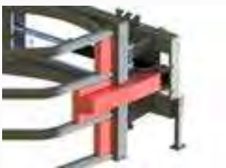
Verstärkte Seitenarme ohne scharfe Kanten
