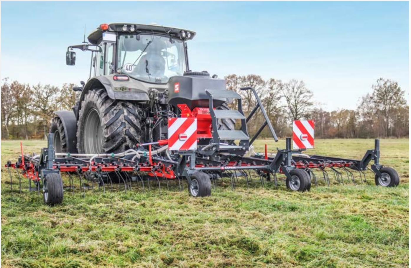
Der Saphir Exaktstriegel Perfekt ES ist speziell für die Grünlandpflege mit kleineren Traktoren und für sehr kuptiertes Gelände entwickelt worden. Durch die exakten Einstellmöglichkeiten eignet sich diese Baureihe auch für die Zwischenfruchtaussaat. Abgestorbenes Altgras und gemeine Risse können effektiv ausgekämmt werden. Die Einebnung von Maulwurfshäufen erfolgt durch die federbelastete Impulsschiene. Frei drehbare Stützräder sorgen für eine optimale Boden Anpassung und Tiefenführung.
