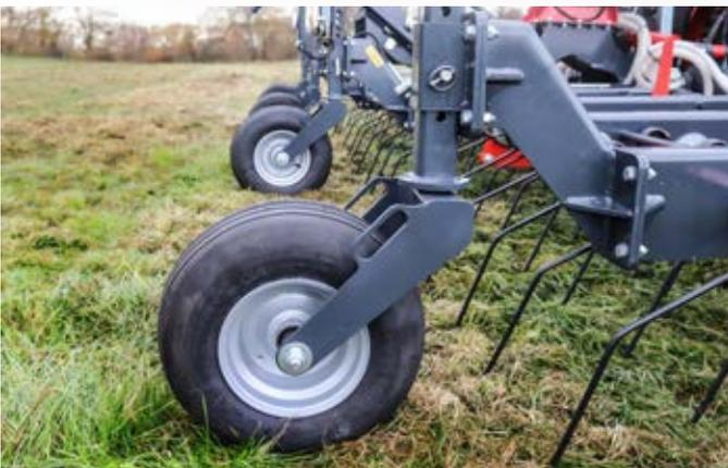
Nachlaufende St utzr ader (luftbereift, frei drehend 90 ) sorgen f ur eine optimale Bodenanpassung und einen ruhigen Lauf.
