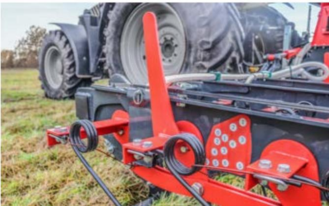
Der Exaktstriegel Perfekt ES verfügt über drehbare Zinkenr ager. Die Verstellung der Zinkenaggressivit at erfolgt mechanisch per Lochraster.
