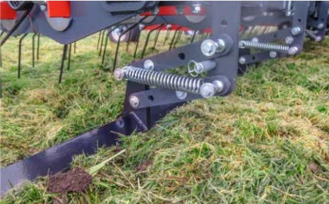
Mit der federbelasteten und parallelgeführten Impulsschiene lassen sich Maulwurfshaufen eibebnen.
