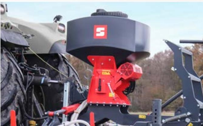
Optional ist das Ger at mit einem SAPHIR DrillStar ausr ustbar. Dieser erm oglicht eine sehr exakte und windunanf allige Nachsaat von Futtergr asern in gesch adigten Best anden.
