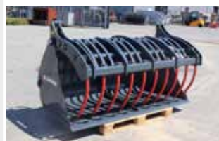
GS 20Z Euro Greifschaufel Lagermaschine Bj. 2023; Euroaufnahme; Breite 2.000 mm; Öffnungsweite 1.450 mm; Inhalt 1.080 l
