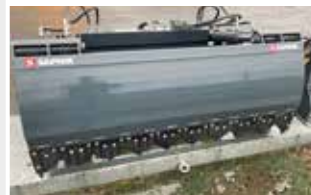
SSE 199 Volvo L30 Silageschneidschaufel Vorführmaschine Bj. 2021; Fahrzeugaufnahme Volvo L30/Claas Torion/CAT/Case/Liebherr/Zettelmeyer; Breite 1.990 mm; Öffnungsweite 850 mm; Inhalt 1.350 l; Farbschäden
