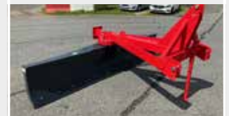
Contour C3000 Planierschild Lagermaschine Bj. 2023; Dreipunktaufnahme Kat. II; Breite 3.000 mm; 360° Schwenkbereich für Front- und Heckeinsetzung; Schildhöhe 550 mm; Kraftbedarf 44 kW / 60 PS; Farbschäden
