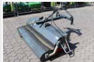
FKM 151 Kehrmaschine Vorführmaschine Bj. 2023; Dreipunktaufnahme Kat. I/II; Arbeitsbreite 1.500 mm; Gesamtbreite 1.850 mm; Bürstendurchmesser 520 mm; Farbschäden
