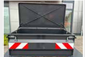
Transportbox TB 140 Lagermaschine Bj. 2023; Euroaufnahme / Kat. I / II; Spritzwassergeschützter Behälter; 1.400 x 700 x 500 mm (B x T x H) (innen); Zul. Gesamtgewicht 1.150 kg
