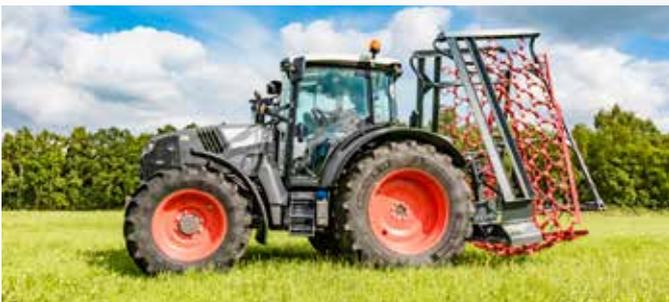
Die Lieferung erfolgt serienmäßig mit hydraulischer Klappvorrichtung und Sicherheitsverriegelung für die bedienerfreundliche Sicherung der Maschine im Straßentransport. Die Maschinen werden grundsätzlich komplett montiert ausgeliefert.
