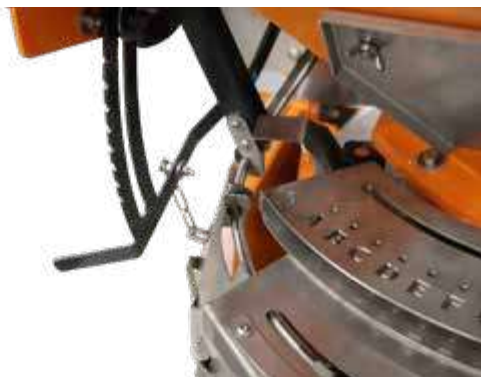
Manuell verstellbarer Streubreitenbegrenzer links / rechts
