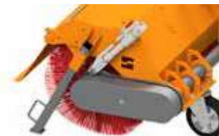
Vertikale Verstellmöglichkeit der Kehrbürste
