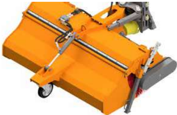
Optionale hydraulische Sammelwanne mit 3. Stützrad
