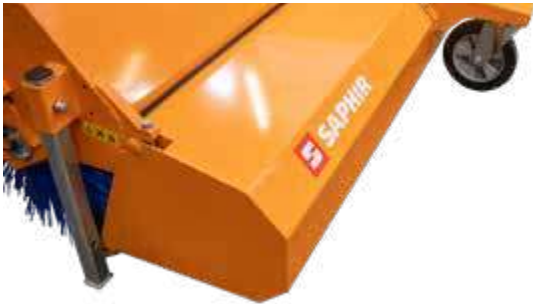
Hydraulische Schmutzsammelwanne mit 3. Stützrad
