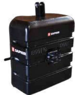
Stahlbetongewicht Standard 800 kg mit Kat. II
