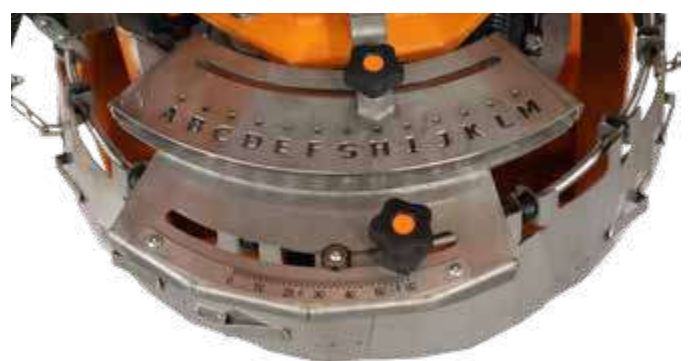
Streumengen- und Streubildverstellung aus Edelstahl über gelaserte Skalen einstellbar.
