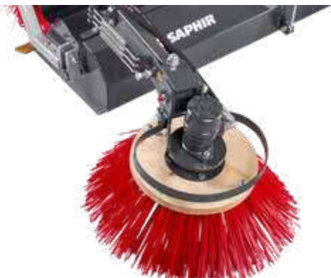
Seitenkehrbesen für das Reinigen an beispielsweise Straßenrändern oder Bordsteinen (kein weiteres Steuergerät erforderlich), optional auch mit Stahlbesatz
