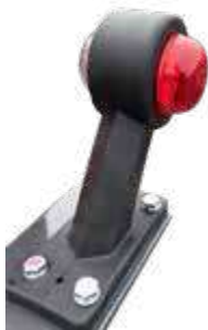
LED Begrenzungsleuchten für den sicheren Straßentransport
