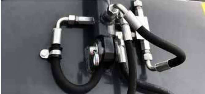
Hydraulische Entleerung für eine einfache Entleerung (kein weiteres Steuergerät erforderlich)
