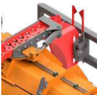
Verstellbarer Anbauturm zum Einstellen des Vorbaumaßes der Kehrmaschine
